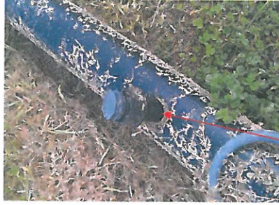
Illustration N15 Prise échantillon dessoudé du puits 1004
